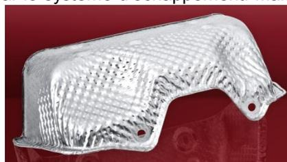
Le nouveau complexe aluminium « sandwich » développé en interne en collaboration avec Lydall Automotive est un aluminium 0,2mm/polymère 0,08mm/aluminium 0,3mm. Utilisé sous forme de bandelettes il permet effectivement d'absorber les vibrations et de réduire les risques de ruptures dues à la fatigue. Les émissions sonores sont complètement éliminées et le confort à l'intérieur de l'habitacle est grandement amélioré.
