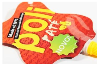
Le sachet composé d'un complexe aluminium 3 couches PET12/Alu8/PE70 est rempli à chaud à 85°C. Une autre version du complexe utilisant un film de polypropylène permet la stérilisation pour obtenir un allongement très important de la durée de conservation. Ainsi, la durée de conservation qui était de 60 jours est portée à 12 mois environ sans avoir à maintenir une température maximum de 4°C tout au long de la distribution du produit, indique AMPAC.
