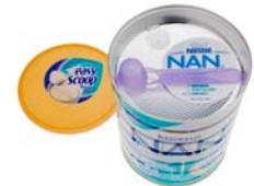
Easy Scoop zeichnet sich durch einen neuen Tiefziehdeckel der Ardagh-Gruppe aus, der eine Alufix® Dry Pro Peel-off-Membran von Amcor Flexibles Singen verwendet und Platz für einen Löffel bietet. Der Boden des Stahldeckels mit der Alufolienmembran wird auf den inneren Teil des Ringes gesiegelt. Die Verpackung ist außerdem mit einer Kunststoffkappe ausgestattet.
