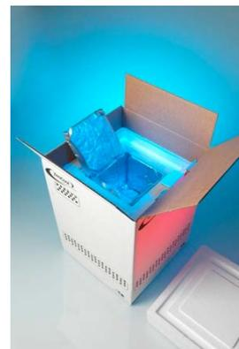
Contrairement aux méthodes traditionnelles, ZeoCool n'utilise pas de composants réfrigérants, lesquels ne permettent pas, en général, de maintenir une température constante. Un dispositif logé dans un contenant en aluminium appliqué sur les six faces intérieures de l'emballage produit soit de la chaleur, soit du froid, par évaporation, sans avoir à recourir à une source extérieure d'énergie.
