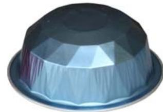
Die 96 glänzenden Fasetten des Behälters werden durch Tiefzieh-Kaltumformung erzeugt. Die 130 µm dünne Alubasisfolie bietet hohe Steifigkeit und ist außen mit einem Schutzlack versehen, der verzerrt werden kann, um spezielle Effekte zu erzielen. Der hohe Barrierschutz der Alufolienschale garantiert lange Haltbarkeit und erlaubt die Sterilisierung bei hohen Temperaturen. Der Easy-peel-Deckel lässt sich leicht abziehen und das Füllgut so einfach und sicher entnehmen.
