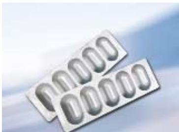
klimatischen Bedingungen eine wirksame medizinische Hilfe oft erschweren.“ Der Formpack®-Verbund hat ein integriertes Trockenmittel auf der inneren Siegelschicht, das das Durchdringen von Feuchtigkeit verhindert und eine 100-prozentige Barriere bildet. Das mehrschichtige Bodenlaminat besteht aus OPA-Alufolie-PE plus dem Trockenmittel und PE; die Abdeckung besteht aus einem Lack-Alufolien-PE-Verbund.
