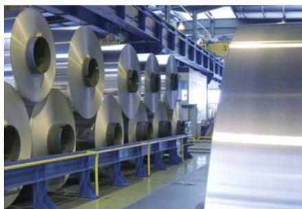
foglio più sottile, utilizzato per l'incarto del cioccolato, può avere uno spessore anche di 6 micron, quello per uso domestico di 11-18 micron, quello per coperchietti di 30-40 micron, mentre i contenitori raggiungono i 40-90 micron. ///
