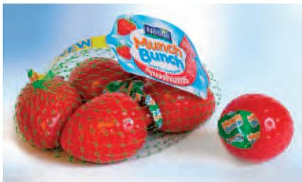
PET/ALU termosaldato facile da aprire, ma che allo stesso tempo garantisce la necessaria protezione igienica per il prodotto. Questi imballi sono ottenuti per allungamento gonfiando 2,4g di PET preformato per confezionare da 60 a 100 g di prodotti viscosi, come ad esempio lo yogurt. Accattivante, giocoso, economico ed ecologico (per questa confezione serve il 50% di materiale in meno rispetto ad una tradizionale), l'imballaggio è caratterizzato da una stampa high-gloss.
