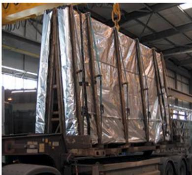
Das Glas wird in die Hülle eingewickelt, die anschließend unter Anwendung eines Vakuum- und Heißsiegelprozesses hermetisch abgedichtet wird. Ein Trockenmittel wie Silikatgel oder Aktivton komplettiert die Packung.
