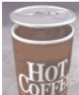
Utilisable pour les boissons liquides, les soupes ou les plats cuisinés, cet emballage innovant comprend une partie centrale qui contient du carbonate de calcium en poudre. Le produit à réchauffer est logé dans la partie annulaire. A la base, on trouve un récipient d'eau fermé par un opercule en aluminium. On trouve aussi une membrane anti-effraction en feuille d'aluminium. Tous ces éléments sont fabriqués avec des matériaux aptes au contact alimentaire.
